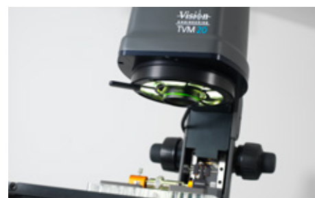
TVMテレセントリック光学系と反射照明
